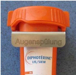
Das Laserbeschriften auf einer Werkzeugmaschine ist leider nicht mit einem Beschriftungslaser zu vergleichen. Die Schriftfarbe kann nicht eingestellt werden und ist braun. Für technische Beschriftungen reicht die Qualität aber oft aus.
