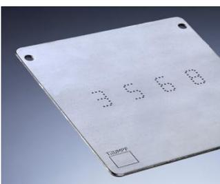
Als signieren bezeichnet man die Herstellung so vieler Körnerpunkte nacheinander, dass eine Schrift entsteht. An signierte Schrift dürfen keine hohen graphischen Anforderungen gestellt werden. Zur Beschriftung oder Nummerierung von Werkstücken ist diese Technologie aber ausgezeichnet geeignet.
