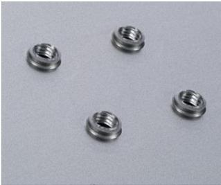
Gewindedurchzüge unterscheiden sich dadurch von den umgeformten Gewinden, indem vor dem Gewindevorgang eine Umformung in Form eines Napfes durchgeführt wird. Damit wird erreicht, dass die Gewindelänge länger wird. Die Gewindedurchzüge können von der Oberseite sowie von der Unterseite hergestellt werden.
