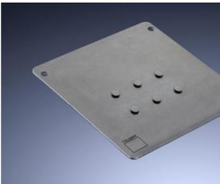
Die Zentrierwarze wird zur genauen Positionierung zweier Bleche eingesetzt. Im Gegenblech erstellt man eine Bohrung mit  $D=3,2$  mm.
